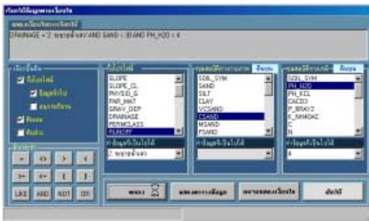
รูปที่ 21 ตัวอย่างของส่วนการโต้ตอบกับผู้ใช้ที่อำนวยความสะดวกในการเลือกตารางเขตข้อมูล และค่าข้อมูลที่เป็นเงื่อนไข
