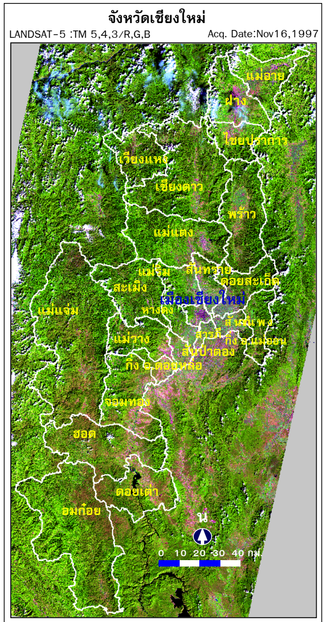
รูปที่ 5-1 ข้อมูลภาพจากดาวเทียม LANDSAT-5 ระบบ TM ที่ใช้จำแนกพื้นที่ข้าวนาปีของจังหวัดเชียงใหม่ บันทึกข้อมูลเมื่อ 16 พ.ย. 2540
